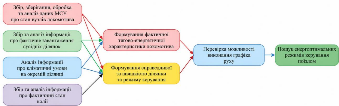
Рисунок 2.11 – Структура процесу пошуку енергооптимальних режимів ведення поїзда
