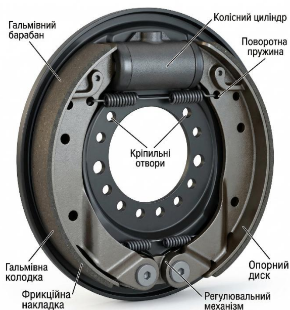
Рис. 1.1. Барабанна гальмівна система.
