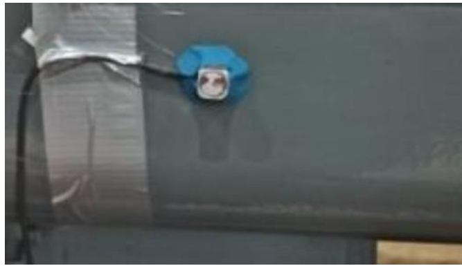
Рисунок 2.7 – Кріплення датчиків прискорення на нижню обв'язку кузова вагона
