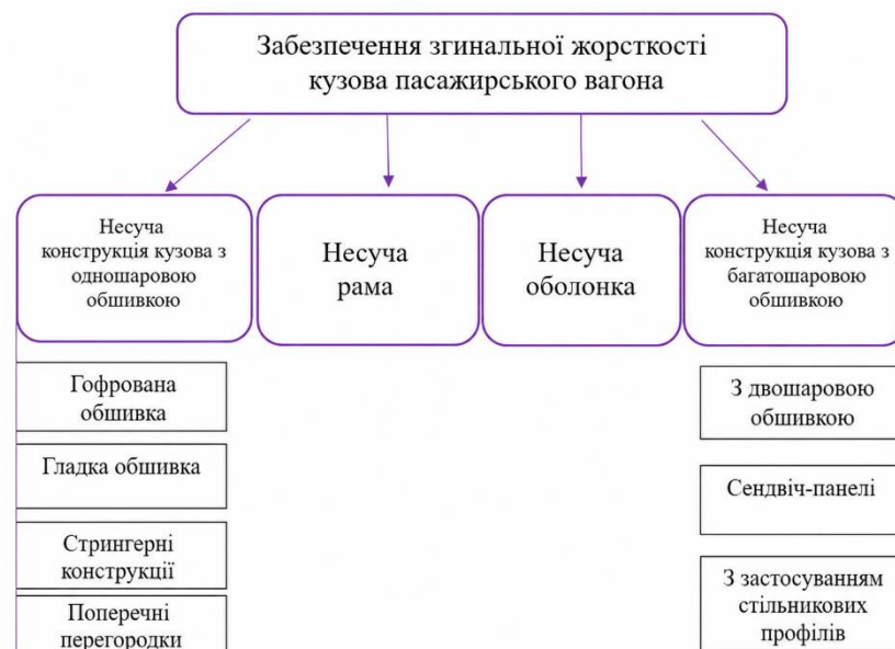
Рисунок 1.1 – Схема забезпечення згинальної жорсткості кузова пасажирського вагона
