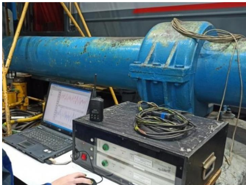
Рисунок 2.9 – Процес фіксації динамічних коливань кузова
