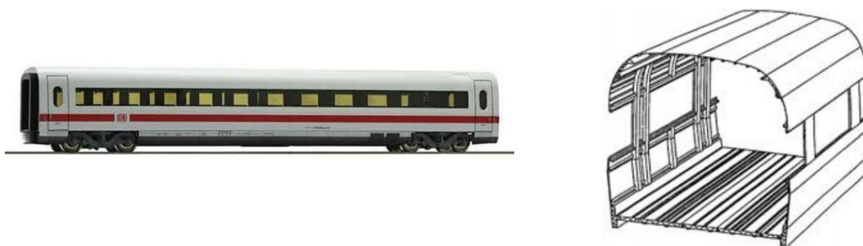
Рисунок 1.7 – Зовнішній вигляд та поперечний переріз вагона ICE
