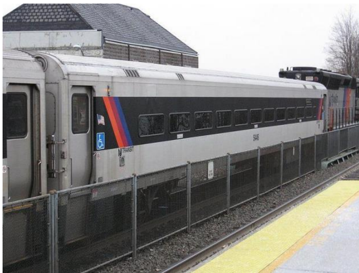
Рисунок 1.4 – Американський вагон для міжміського сполучення Comet з кузовом із алюмінієвого сплаву
