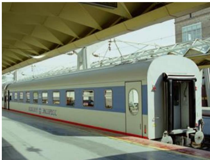
Рисунок 1.11 – Пасажирський вагон з гладкою обшивкою моделі 61-4170
