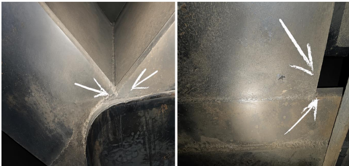
Рисунок 1.11 – Тріщини, що виникли у зварному шві головної рами маневрового тепловоза ТЕМ2
