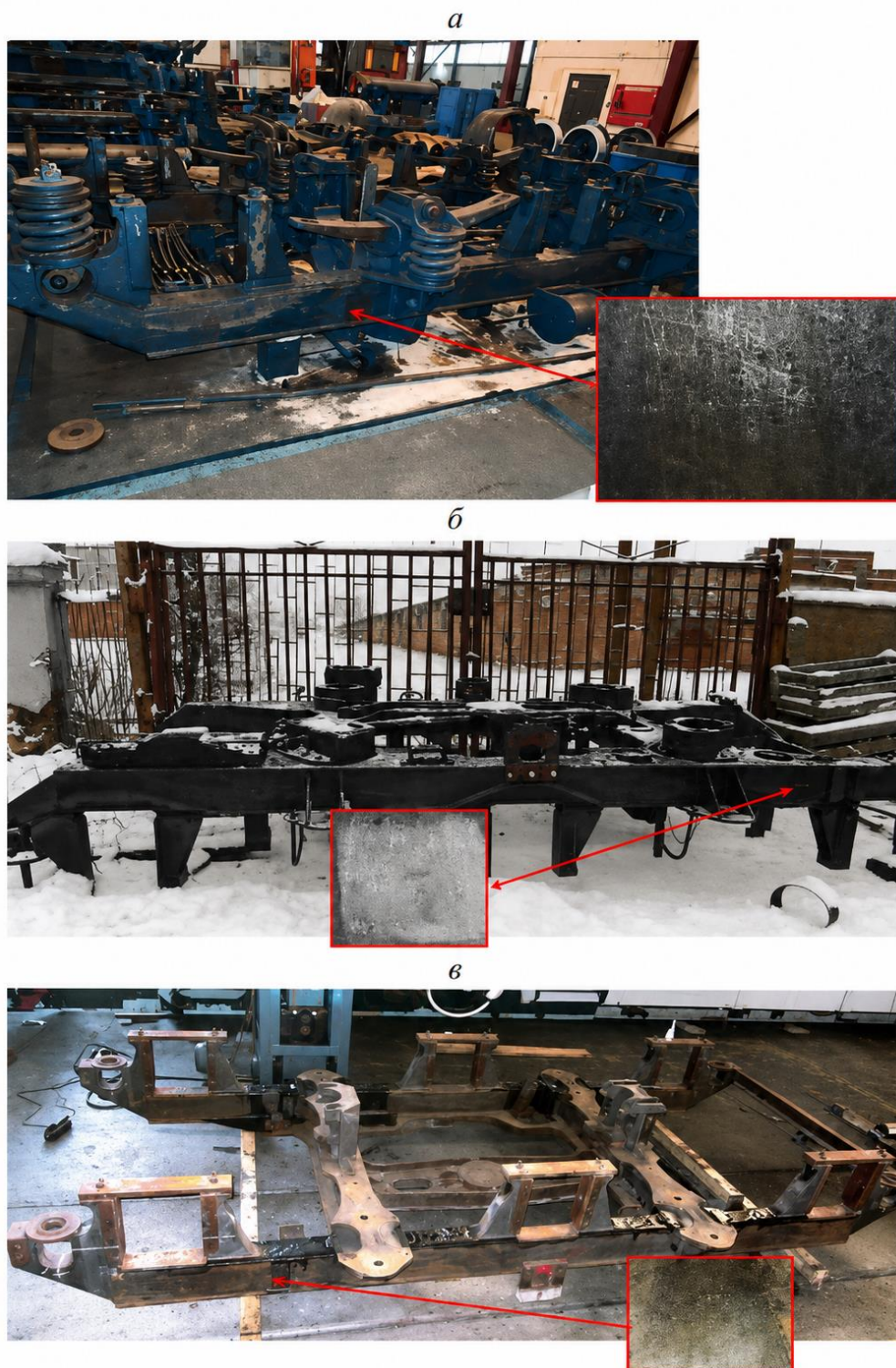
Рисунок 1.9 – Рами візків маневрового тепловоза з ушкодженнями втомного характеру та корозійного зносу (а, б, в)
