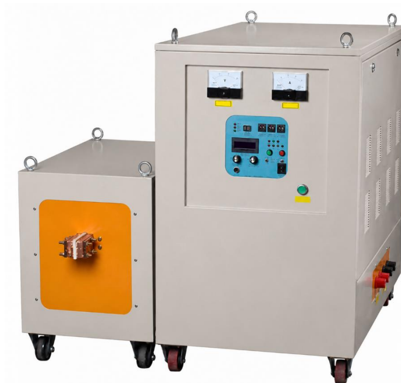
Рисунок 3.3 – Установка УИ-80АВн для нагрева ТВЧ при борировании восстановленных поверхностей корпуса автосцепки
