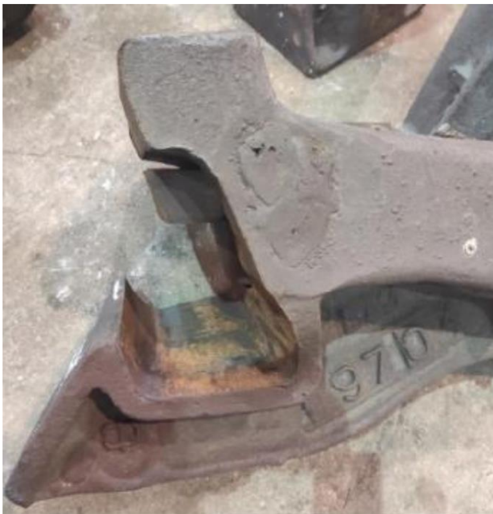
Рисунок 2.2 – Зношування контуру зачеплення
