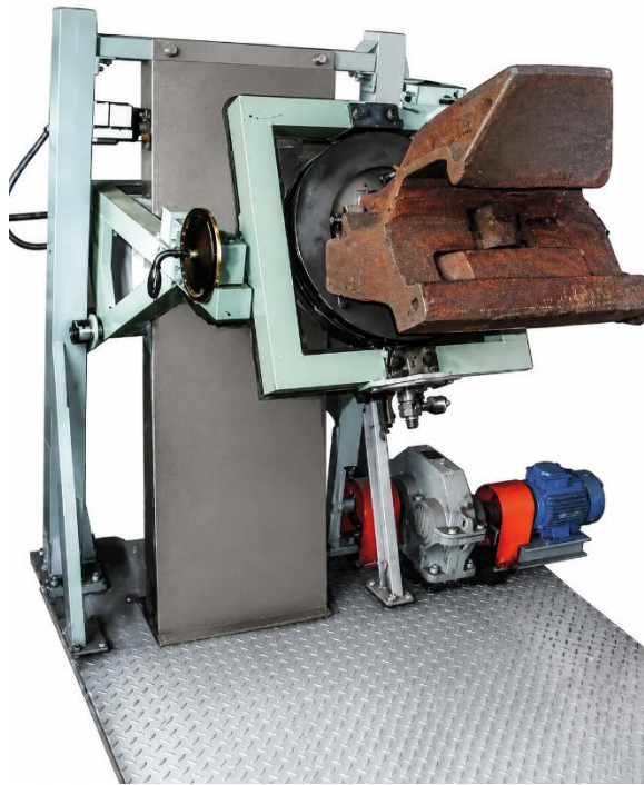
Рисунок 3.2 – Маніпулятор Т7.54.00.000 для фіксації корпусу автозчеплення під час проведення процесу буровання
