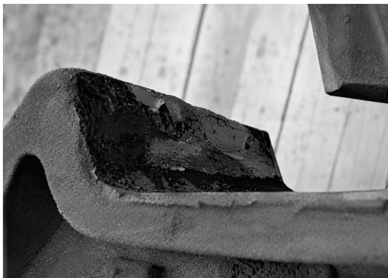
Рисунок 3.1 – Зношена тягова поверхня великого зуба корпусу автозчеплення
