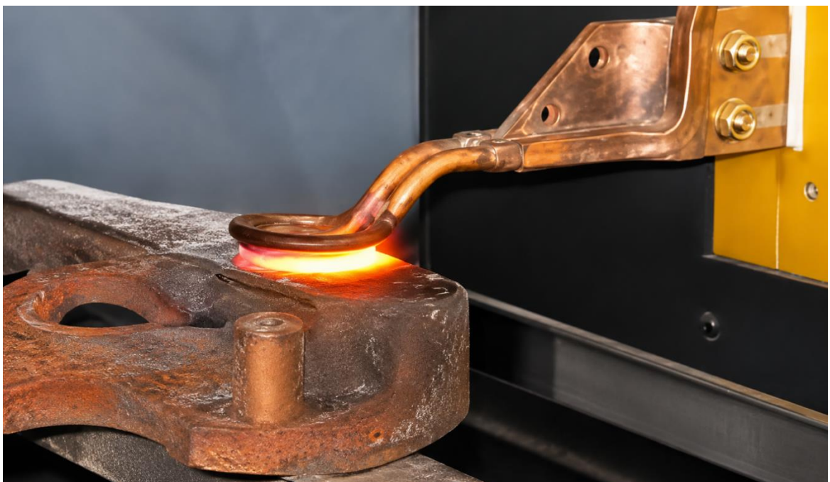
Рисунок 1.7 – Індукційне наплавлення замку автозчеплення
