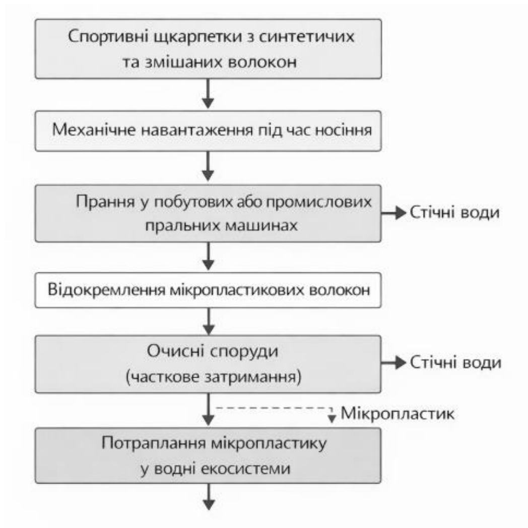
Рис. 2.2. Схема утворення та поширення мікропластику під час експлуатації спортивних шкарпеток
