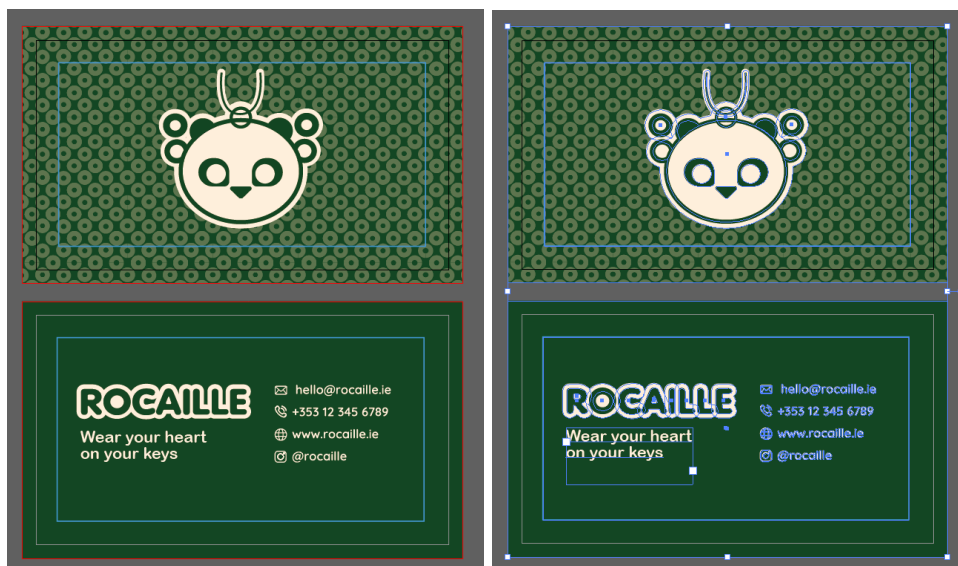
Рис. 3.1. Робоче середовище векторного редактора із налаштуваннями вильотів під обріз (Bleeds) та безпечної зони (Safe zone) для макетів візитівкових карток
