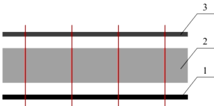
Рисунок 3.12 – Переріз пакету зйомної частини головного убору: 1-підкладка, яка контактує зі шкірою; 2- неткане полотно; 3- зовнішня підкладка.
