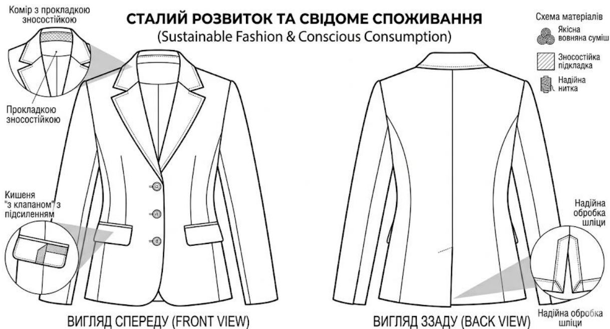
Рис. 1.4. Концепції Sustainable Fashion: технічне рішення жакета з посиленими вузлами обробки
