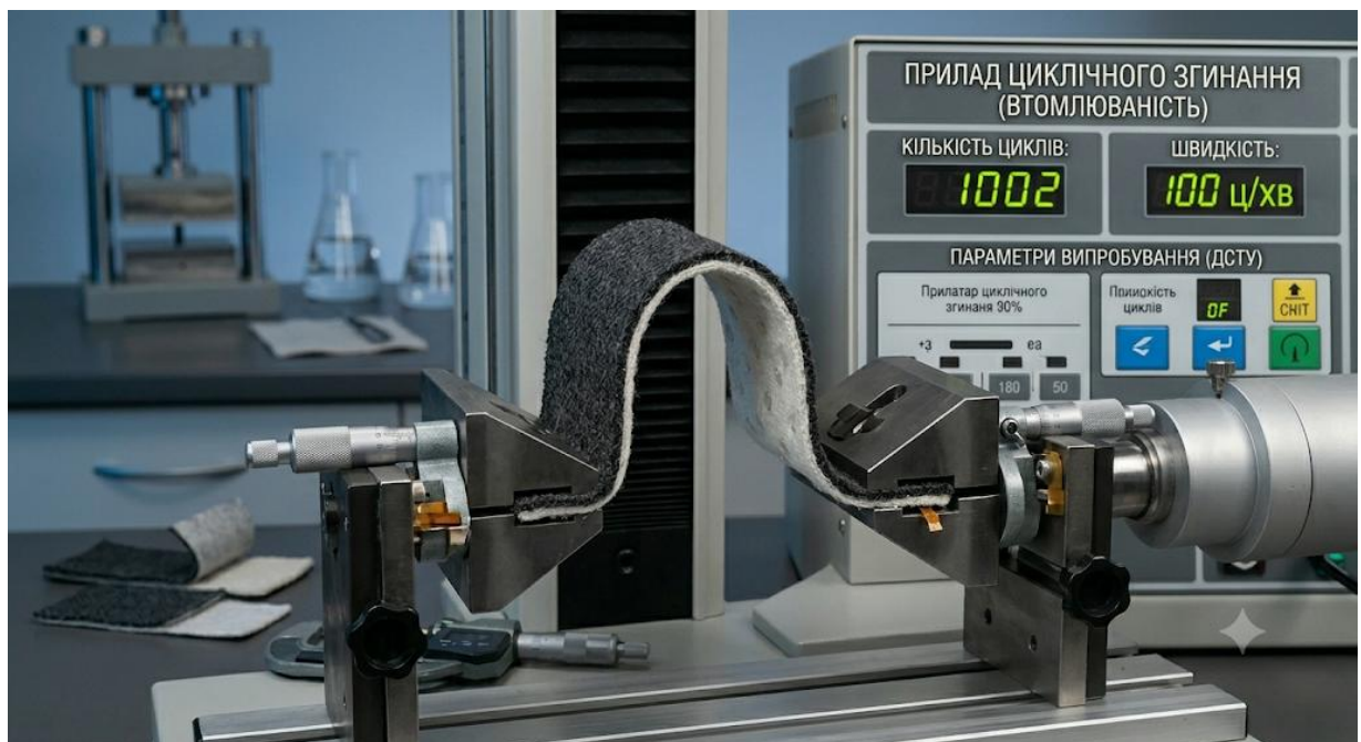
Рис. 3.3. Процес випробування на формостійкість дубльованого Пакета 1 (Вовна + Дублерин) шляхом циклічного згинання на лабораторній установці втомлюваності
