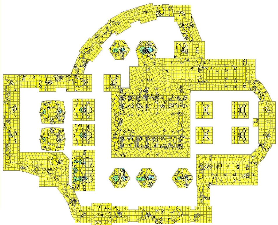
Рисунок Б.6 - Перерізуюча сила Q_x у плитному ростверку (т/м)
