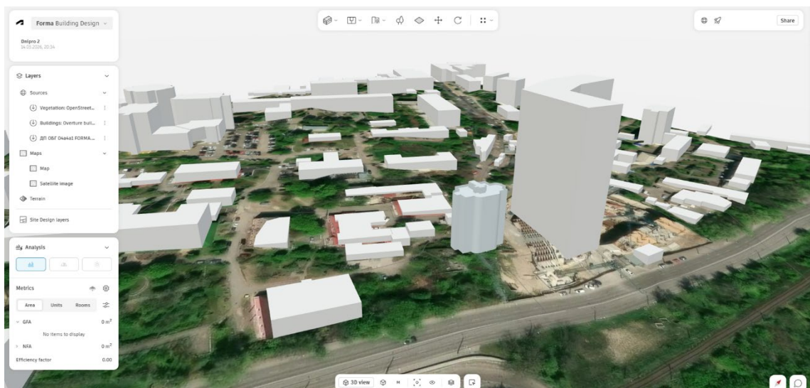
Рисунок 35. Імпорт моделі «ДП ОБГ 04а4а1.obj» у хмарну програму Forma Building Design від компанії Autodesk
