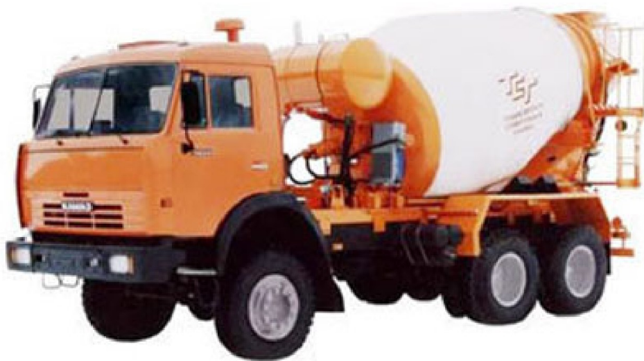
Рисунок В.3 - Автобетонозмішувач АБС-581462
