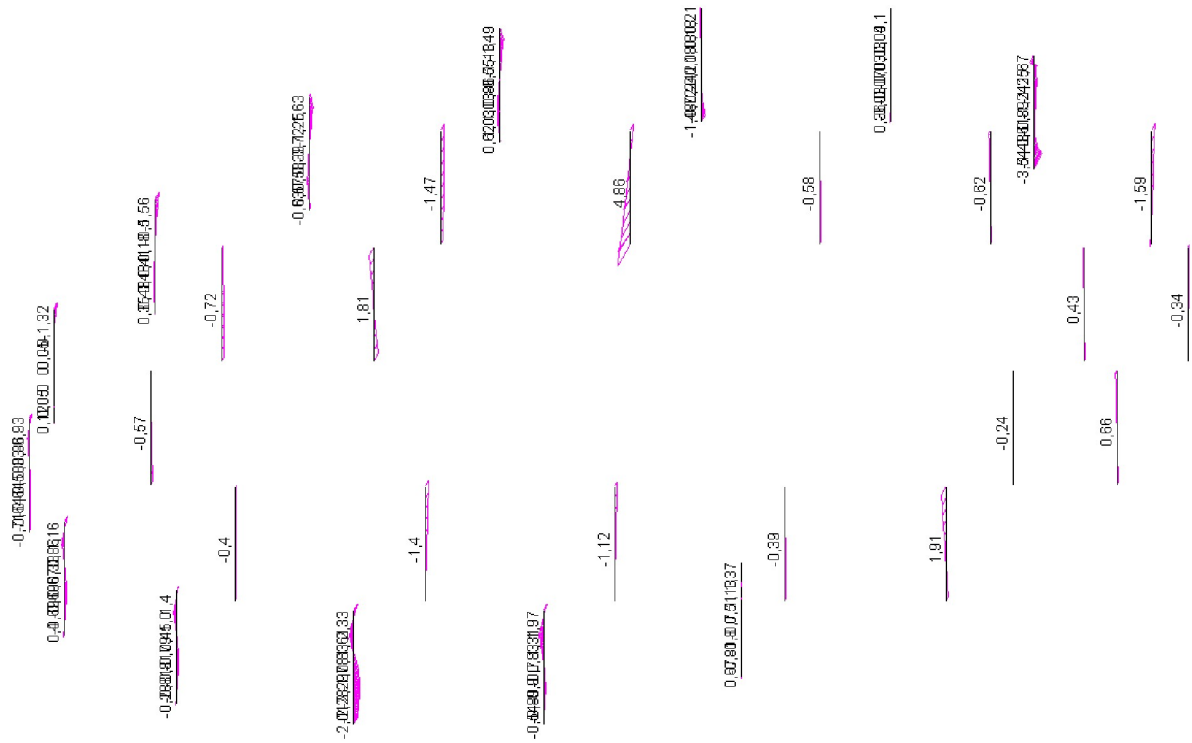
Рисунок 2.25 - Момент M_z в колонах підвалу
