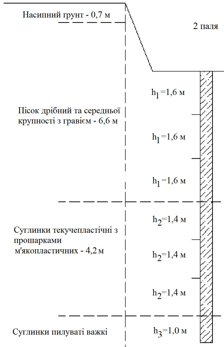
Рисунок 2.2 - Схема палі 2 при довжині 10,0 м
