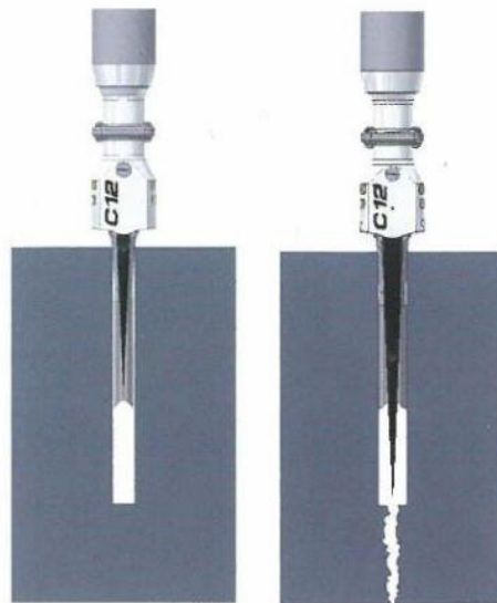
Рис. 3.1 Схема руйнування породи клиновим механізмом гідравлічного сплітера
