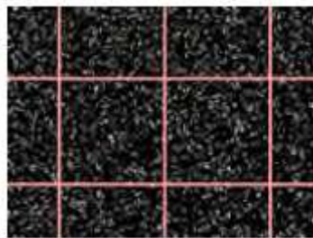
Рис. 3.5 Зображення сегментовано на вікна дослідження за допомогою сітки 64x64 пікселів.
