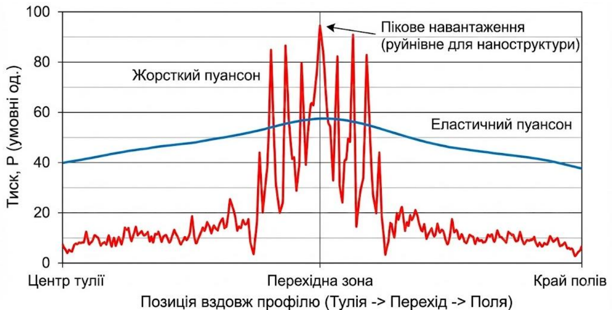
Рис. 2.5 Графічна залежність розподілу тиску під час формоутворення головного убору
