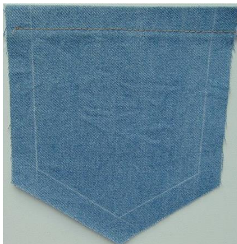
Рис. 4.2. Обробка кишені на пілочці куртки
