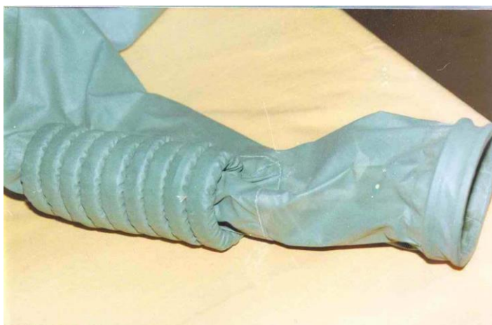
Рис. 3.5. Фрагмент костюма. Ліктюва амортизаційна накладка. Низ рукава з вклеєним кріпильним кільцем
