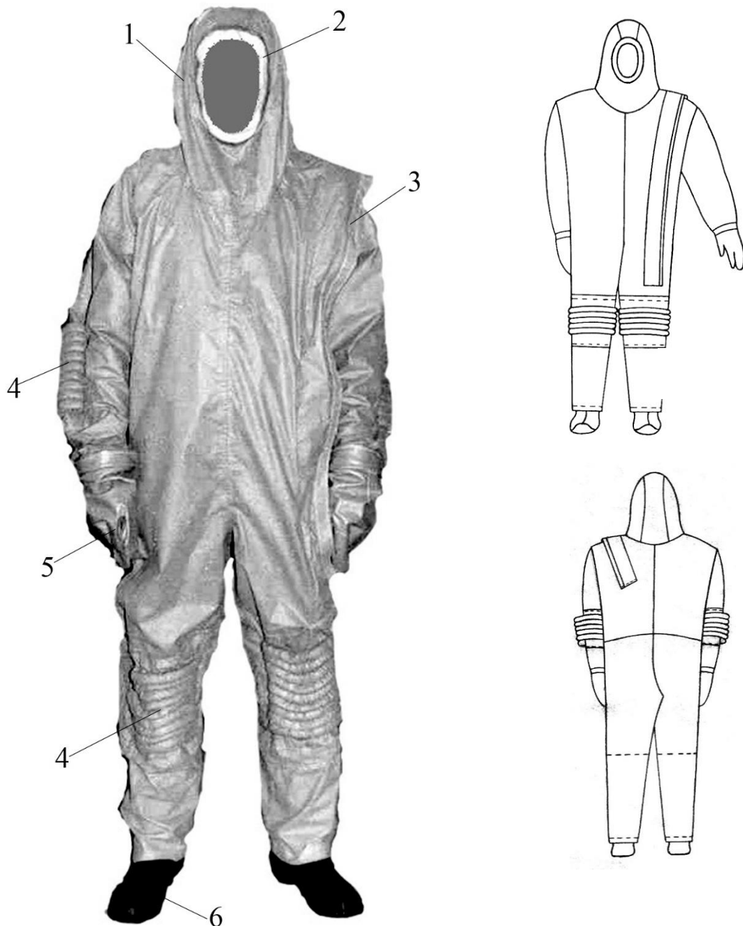
Рис. 3.1. Спеціальний костюм для робіт з очищення ємкостей (вид костюма з боку переду): 1 – капюшон; 2 – обтюратор; 3 – лаз; 4 – ліктьові та наколінники; 5 – трипалі рукавиці; 6 – чоботи; 7 – герметичні панчохи
