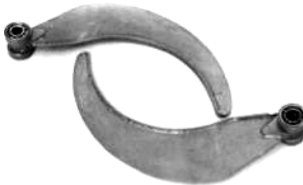
Рисунок 3.2 – Загальний вид прорізних ножів
