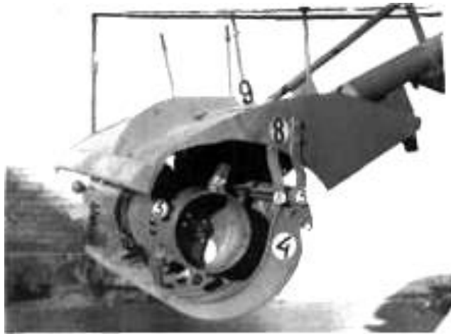
Рисунок 3.1 – Комбінований віддільник стеблових кормів
