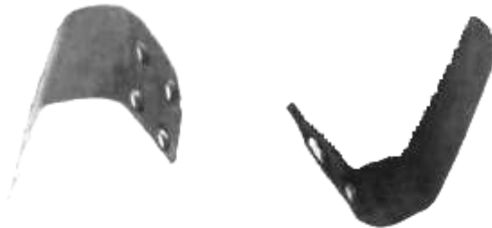
Рис. 3.4. Фрезерні ножі віддільника
