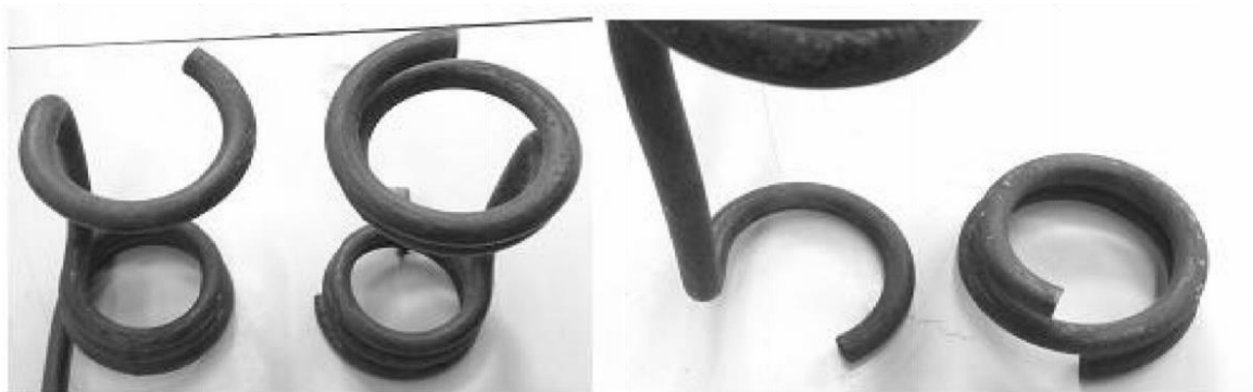
Рисунок 3.7 - Зруйновані зубопружинні робочі органи
