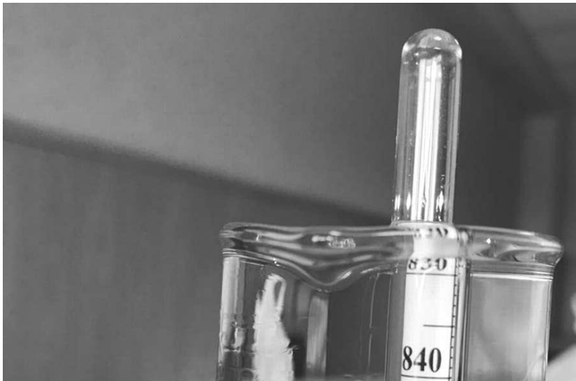
Рисунок 3.2 - Вимір густини необробленого палива
