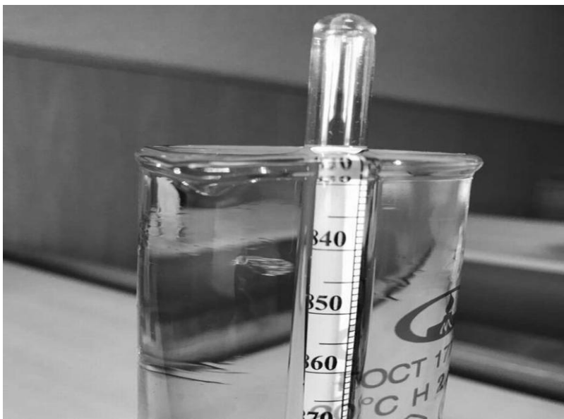
Рисунок 3.3 - Вимір густини дизельного палива після 30-ти секундної обробки
