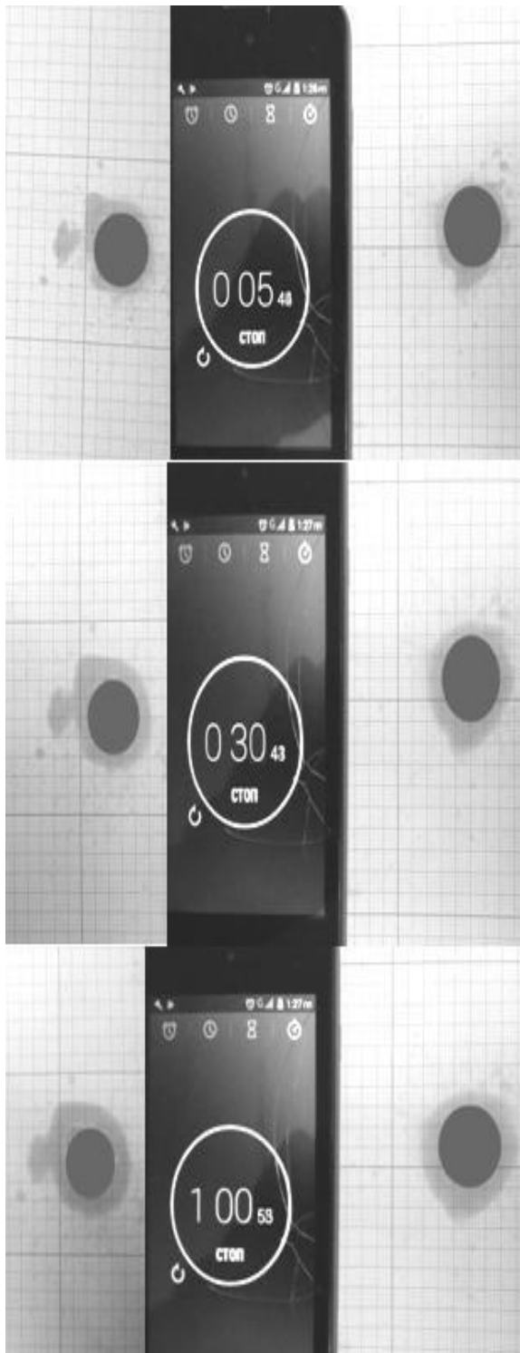
Рисунок 3.8 - Визначення нерівномірності при збільшенні площі змочуваної поверхні за часом необробленим (ліворуч) і обробленим (справа) паливом методом накладення круга
