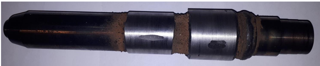
Рисунок 27 - Дослідний зразок після механообробки і виміру твердості
