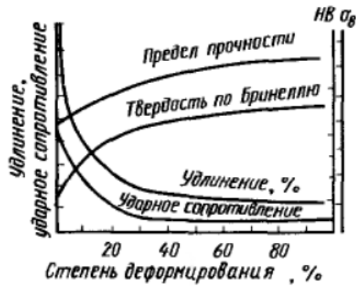
Рисунок 12 - Характер зміни властивостей металу поверхневого шару від міри деформації [6]
