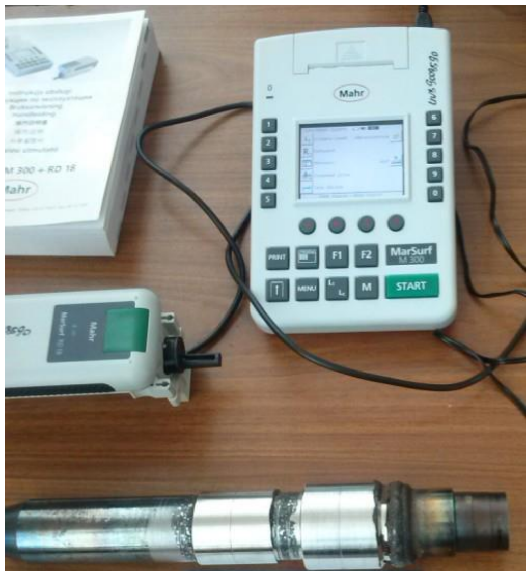
Рисунок 31 - Процес виміру шорсткості
