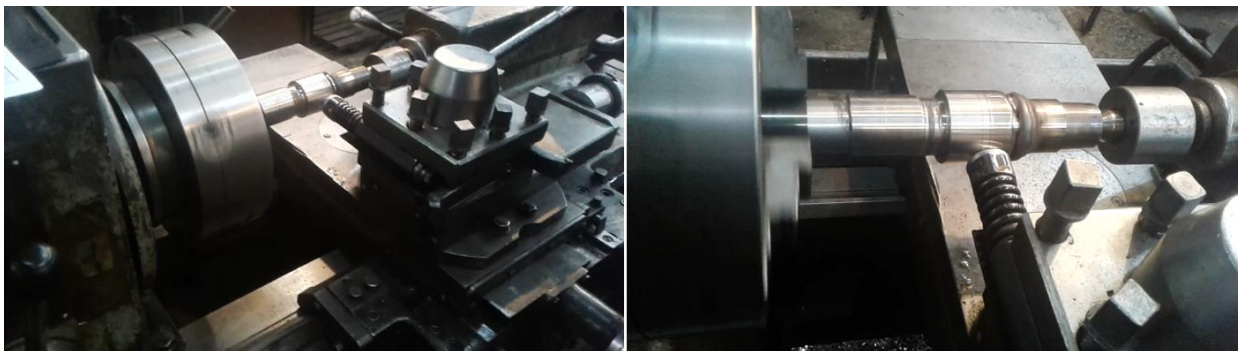
Рис.нок 28 - Процес обкатки кульовим інструментом
