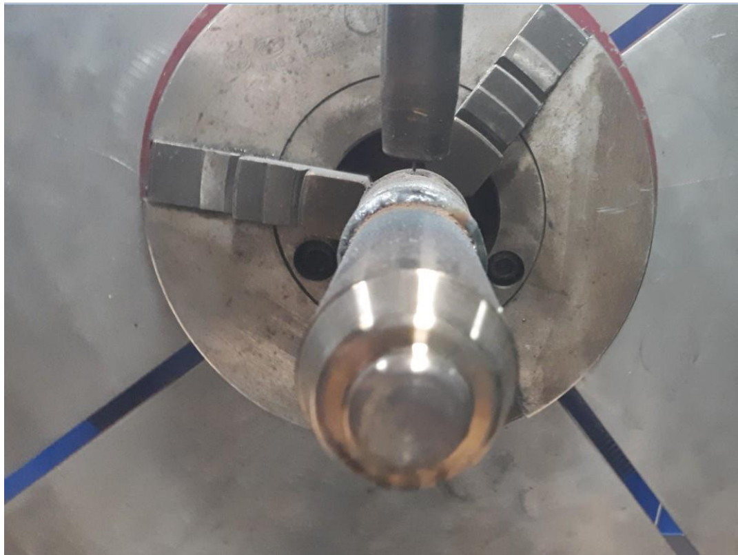
Рисунок 26 - Процес наплавлення дослідного зразка
