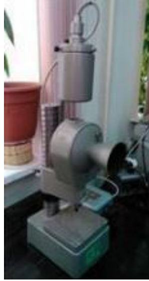
Рисунок 2.12 - Загальний вигляд ультраоптиметра фірми «Carl Zeiss Jena»
