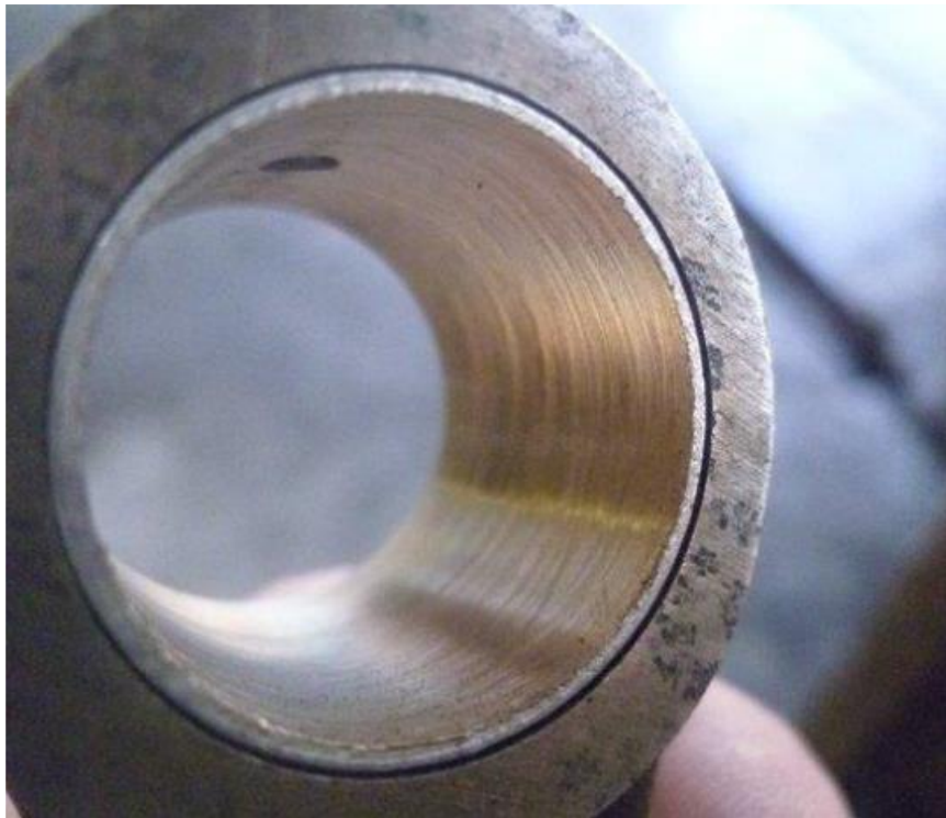
Рисунок 1.7 - Фото отвору після дорнування
