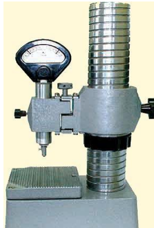
Рисунок 2.10 Загальний вигляд мікрокатора, закріпленого в стійці
