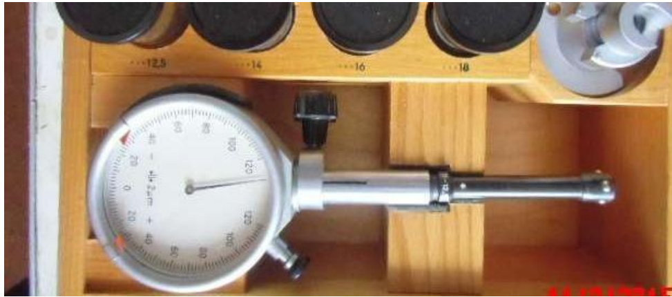
Рисунок 2.8 - Нутромір підвищеної точності «Carl Zeiss Jena»
