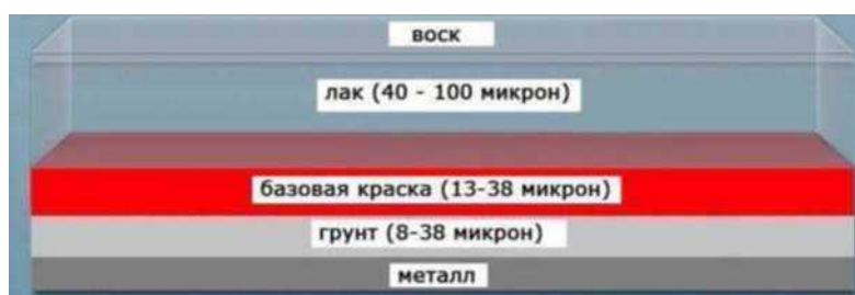
Рисунок 1 - Будова лакофарбного покриття
