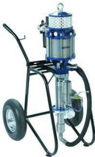
Рисунок 3.1 - Облаштування безповітряного розпилення
