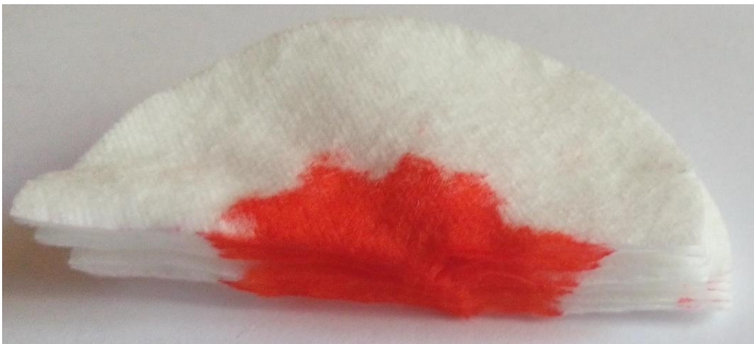
Рис. 3.7. Визначення розповсюдження рідини всередині матеріалу
