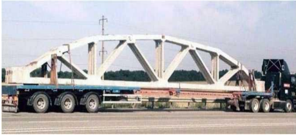
Рисунок 2.5 - Транспортування будівельних ферм
