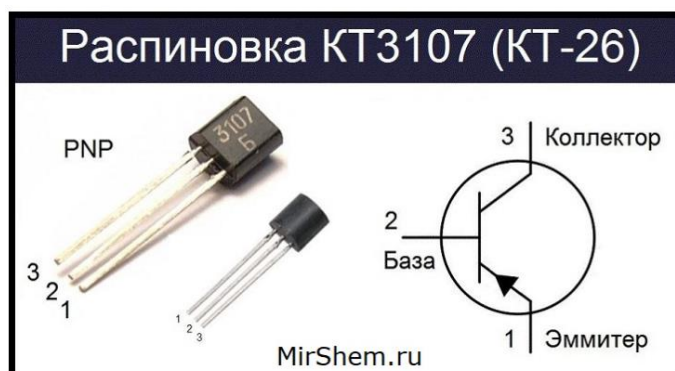
Рисунок 13. Розпинування біполярного транзистора КТ3107D
