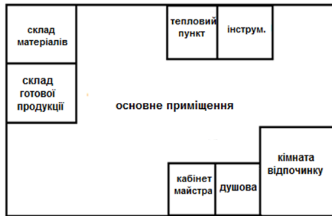
Рисунок 3.1 – План приміщення токарного цеху
