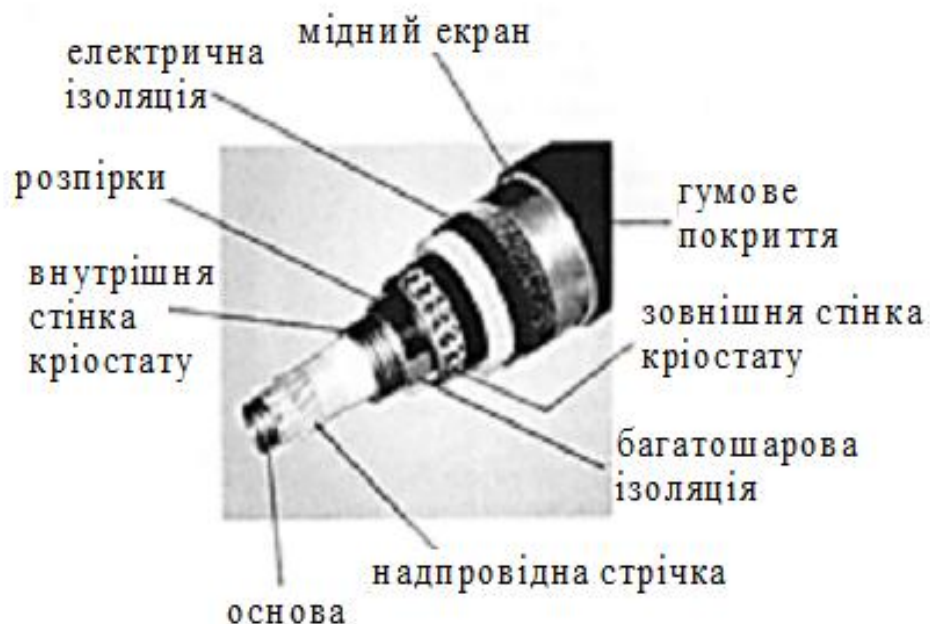
Рисунок 8.5 – Конструкція надпровідного кабелю
