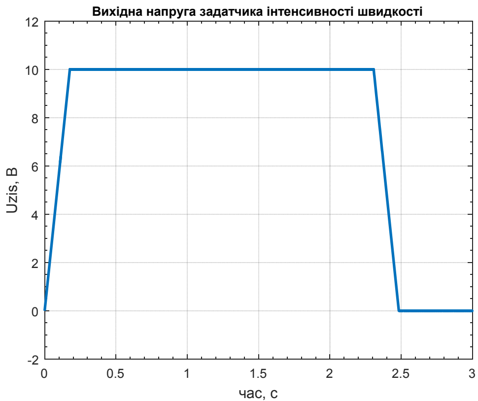
Рисунок 5.7 – Графік перехідного процесу напруги задатчика інтенсивності швидкості ( I_c = 0,4I_H )
