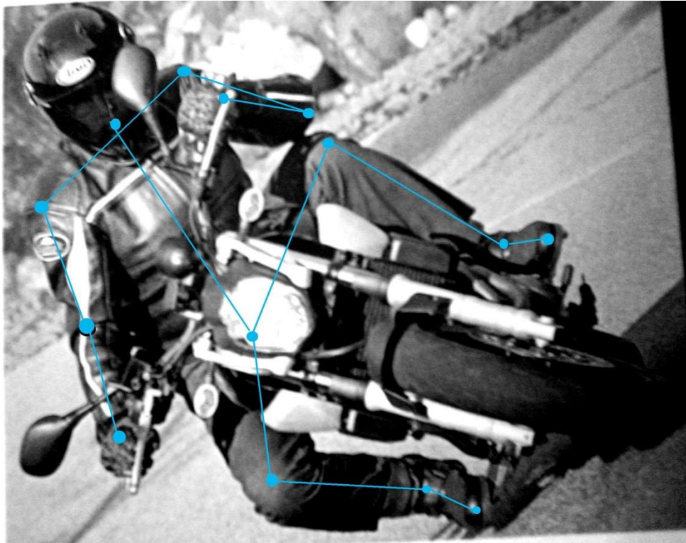
Рис. 2.3. Характерна поза байкера (під час повороту) з визначеними антропометричними точками
