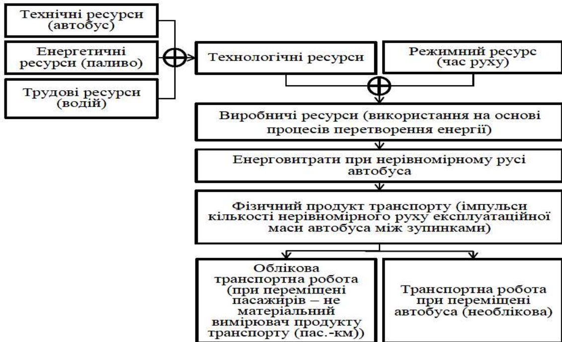
Рис.2.3. Енергетична схема перетворення ресурсів у перевізному процесі
