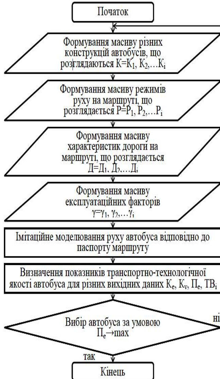
Рис.3.2. Алгоритм багатоваріантного аналізу для оцінки автобуса за енергоефективністю
