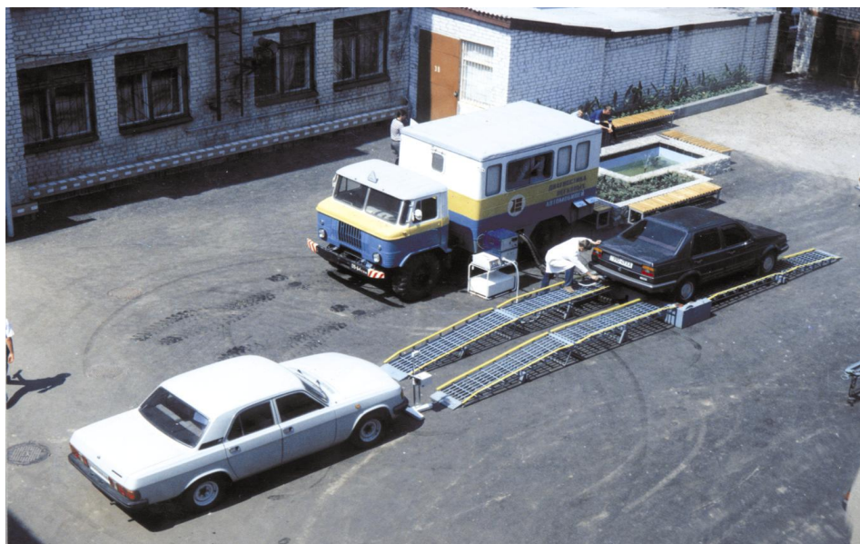
Рис. 3.3. Пересувна станція діагностики легкових автомобілів ПДС-1ГАІ в робочому положенні
