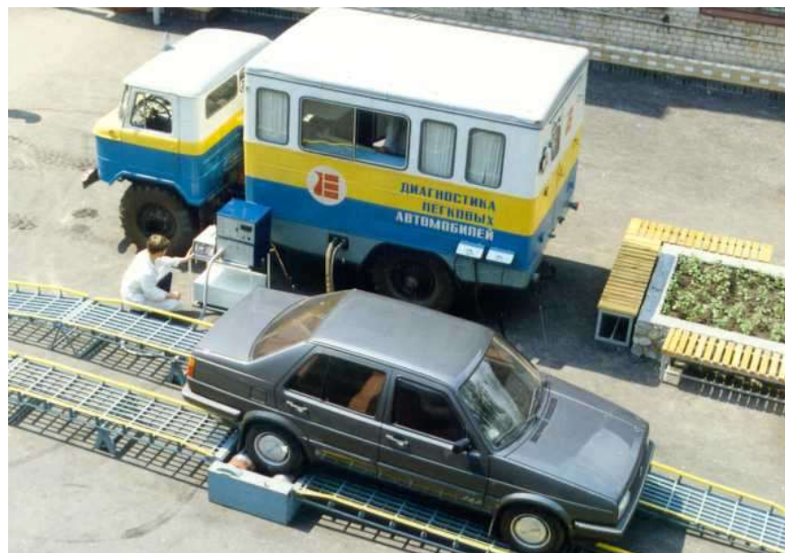
Рис. 3.5. Пересувна станція для перевірки легкових автомобілів ПДС - 1ГАІ конструкції ХАДІ
