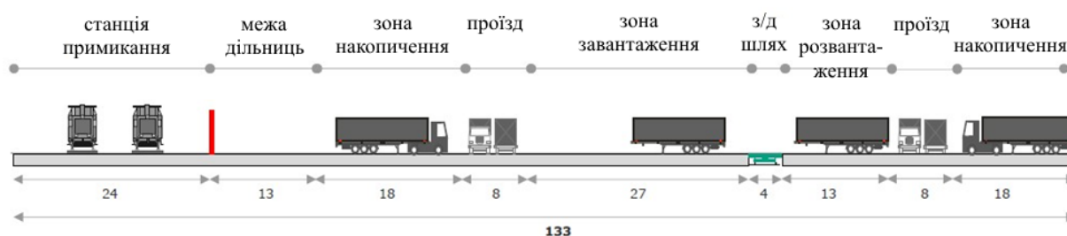
Рисунок 3.14 – Поперечний переріз контрейлерного терміналу (технологічні зони)
