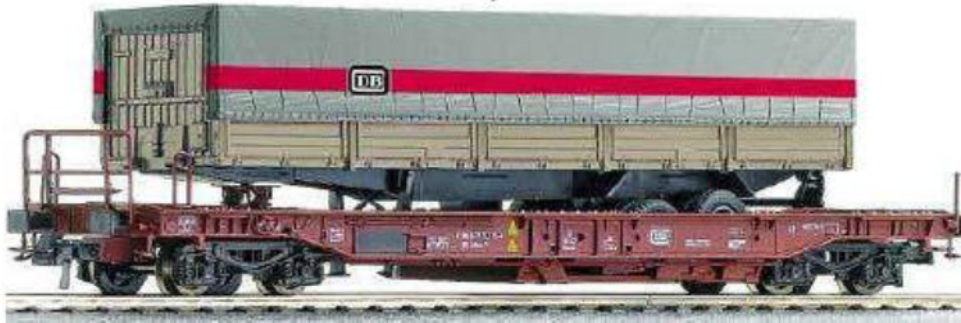
Рисунок 3.7 – Контрейлерна технологія Lo-Lo:
