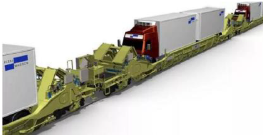
Рисунок 3.5 – Контрейлерна система Flexiwaggon:
