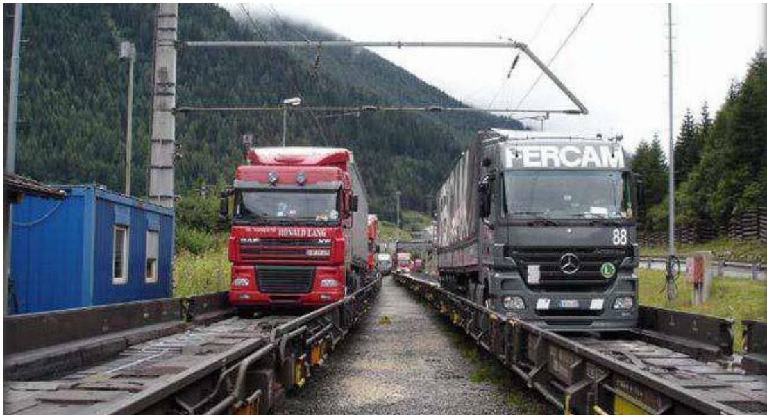
Рисунок 3.6 – Контрейлерна технологія «Rollende Lanstrasse»
