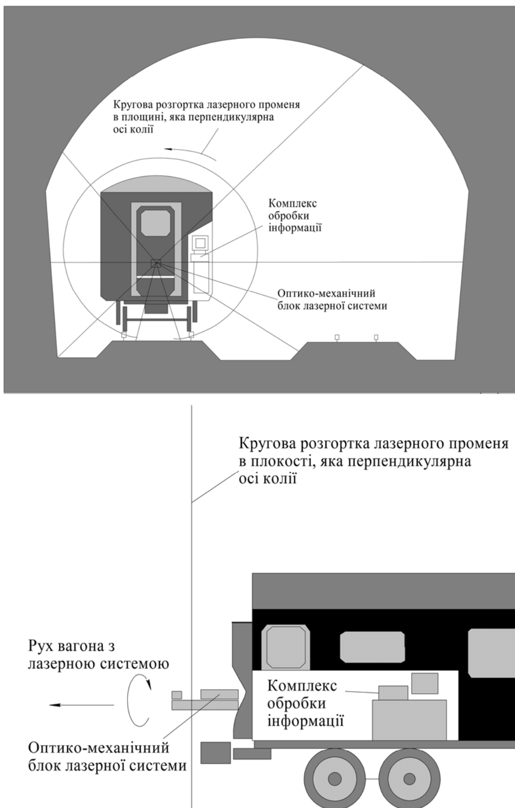
Рис. 2.1 Схема сканування простору і побудови сукупності профілів об'єктів, що обміряються
