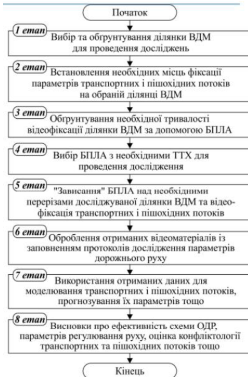
Рисунок 3.1 – Структурна схема імітаційної моделі дослідження параметрів транспортних і пішохідних потоків із використанням запропонованого способу [7]
