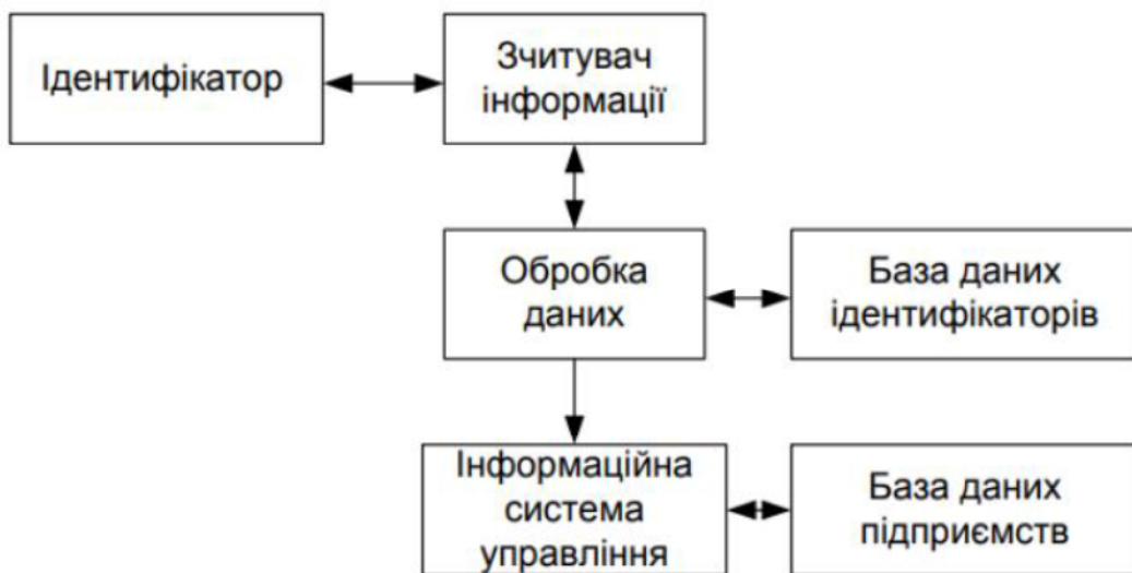
Рисунок 3.3 – Принципова схема роботи системи автоматичної ідентифікації
