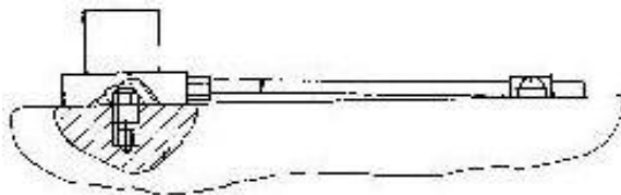
Рисунок 2.4,а – Встановлення датчика за допомогою шпильки
