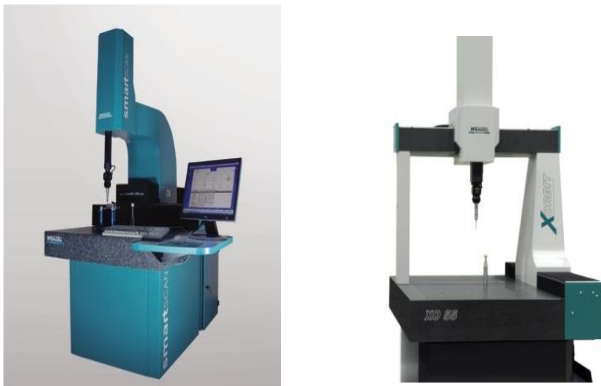
Рис. 3.2 – Загальний вид координатно-вимірювальної машини типа Wenzel XOrbit 55
