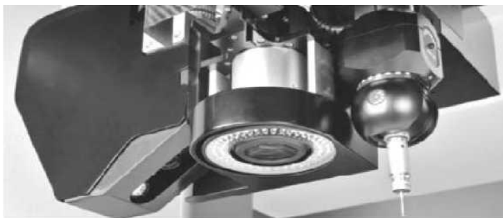
Рисунок 1.3 – Приклад мультисенсорної системи, що включає лазерний сканер і контактний щуп
