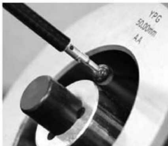
Рисунок 1.1 – Виконання контактних вимірювань за допомогою щупа
