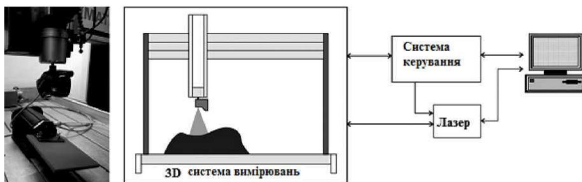
Рисунок 1.2 – Загальний вигляд і принципова схема роботи установки тривимірних безконтактних лазерних вимірювань
