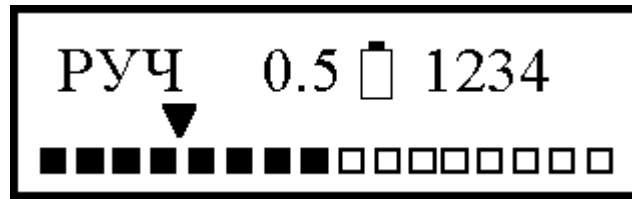
Рисунок 1.2 – Інформація, що відображається на рідкокристалічному дисплеї приладу ВД-30
