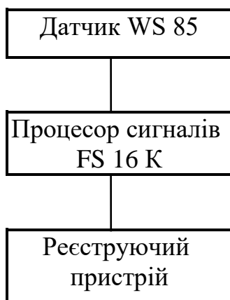
Рисунок 3.5 - Структурна схема ВК об'ємної концентрації водню й температури
