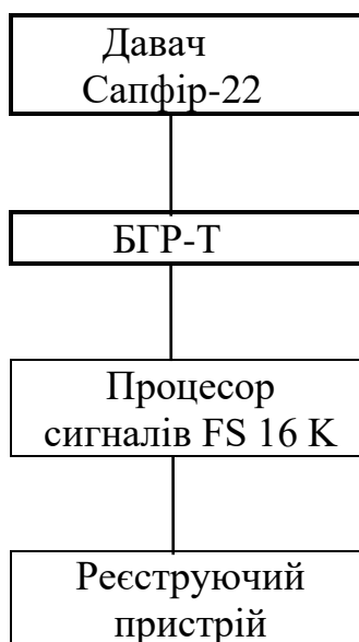
Рисунок 3.6 - Структурна схема ВК тиску
