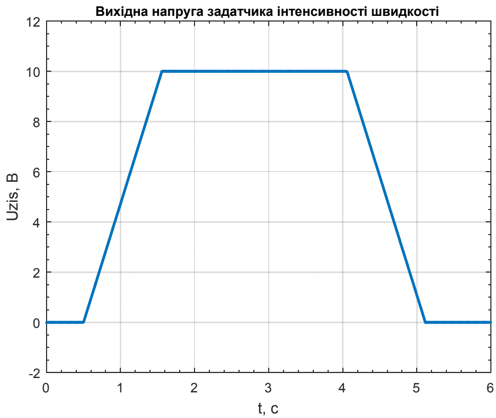
Рисунок 3.15 – Графік перехідного процесу напруги задатчика інтенсивності швидкості
