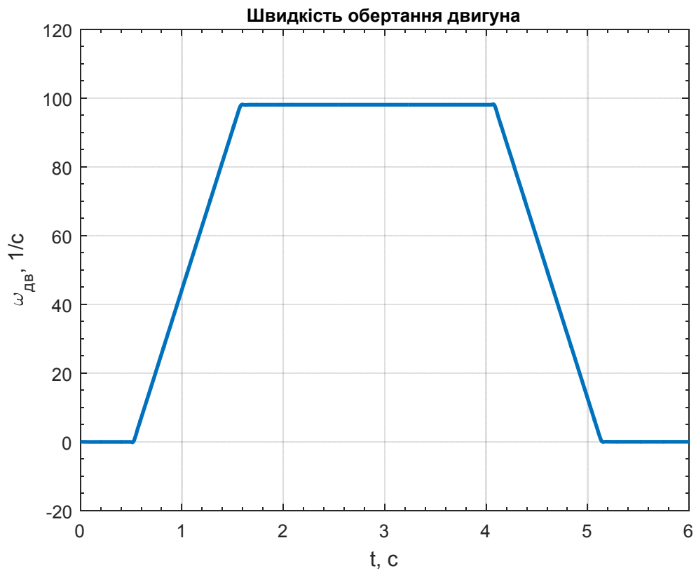
Рисунок 3.16 – Графіки перехідного процесу швидкості обертання двигуна ( I_c = 0,3I_H )
