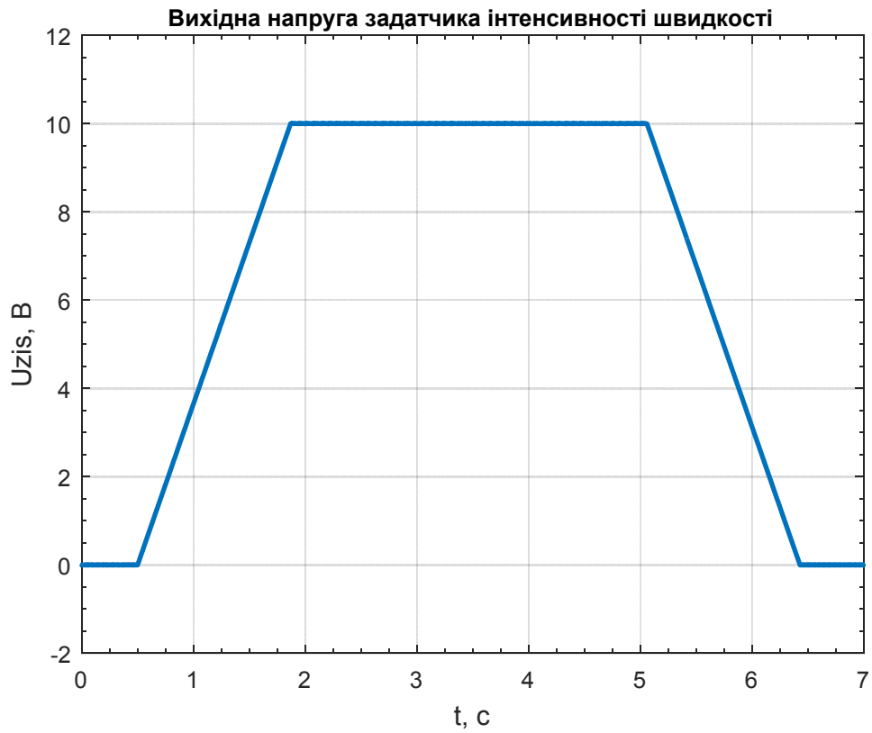
Рисунок 3.18 – Графік перехідного процесу напруги задатчика інтенсивності швидкості
