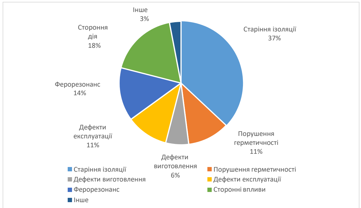
Рисунок 1.13 – Причини пошкодження трансформаторів напруги
