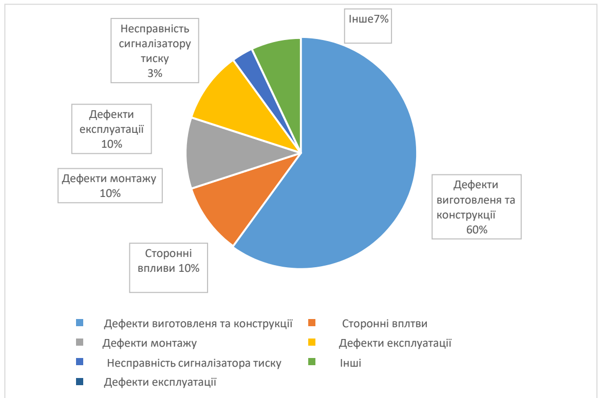
Рисунок 1.16 – Причини ушкоджень елегазових трансформаторів струму
