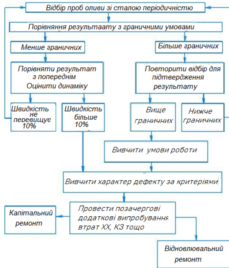
Рисунок 3.25 – Алгоритм прийняття рішення для аналізу розчиненого газу
