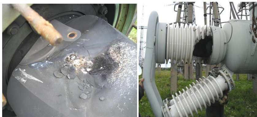
Рисунок 4.3 – Пошкоджений епоксидний ввід високовольтного вимикача
