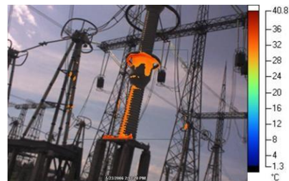
Рисунок 5.4 – Використання IR-Fusion - технології поєднання термо- та відео-зображення
