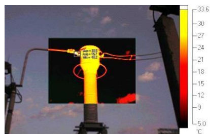
Рисунок 5.4 – Використання IR-Fusion - технології поєднання термо- та відео-зображення
