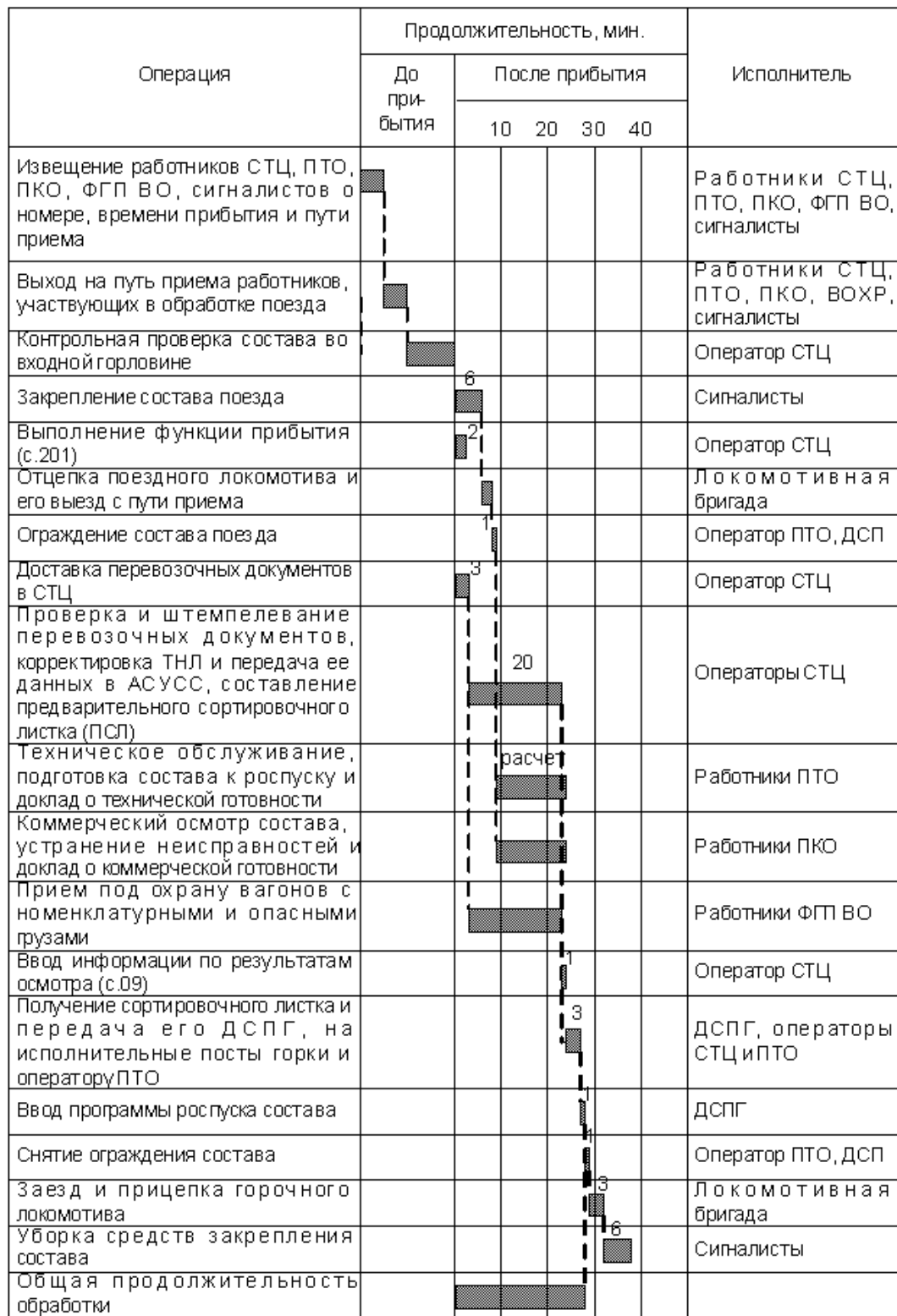
Рис. 2.1. Технологічний графік обробки поїзда, прибулого в розформування в парк прийому
