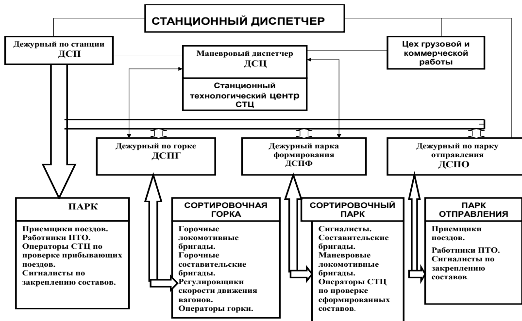
Рис. 2.3. Технологія управління сортувальною гіркою
