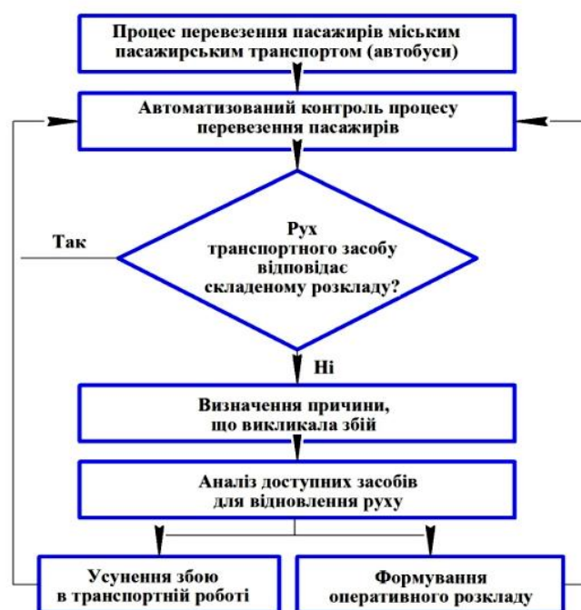
Рис.2.12. Схема диспетчерського управління пасажирським транспортом
