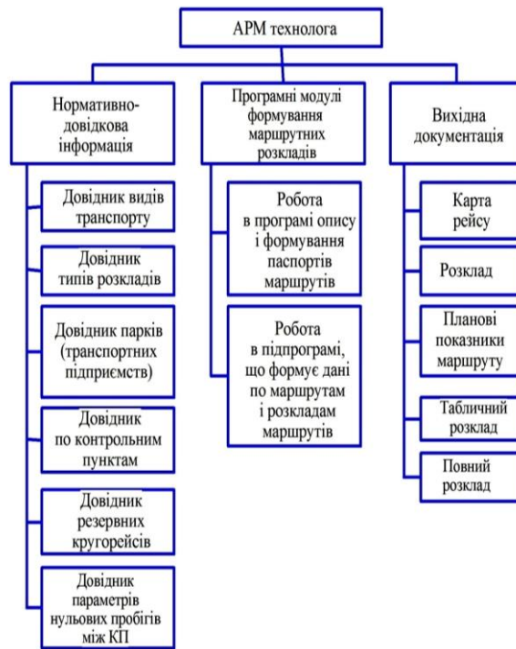
Рис.2.9. Загальна схема реалізації прикладного програмного забезпечення АРМ технолога
