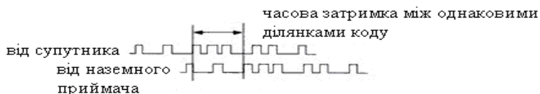
Рис. 2.8. Визначення затримки часу прийнятого сигналу супутника відносно сигналу приймача РО
